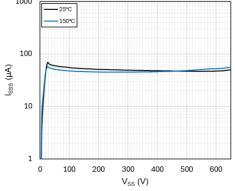
Fig. 5. I<sub>SSS</sub> vs. V<sub>SS</sub>, T<sub>JUNC</sub> = 25°C, 150°C
